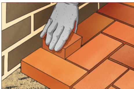
Укладка очередных рядов клинкерной брусчатки.
